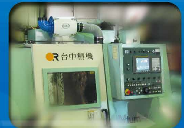
油霧回收機安裝案例
